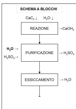
Figura B1 – Schema del processo produttivo
